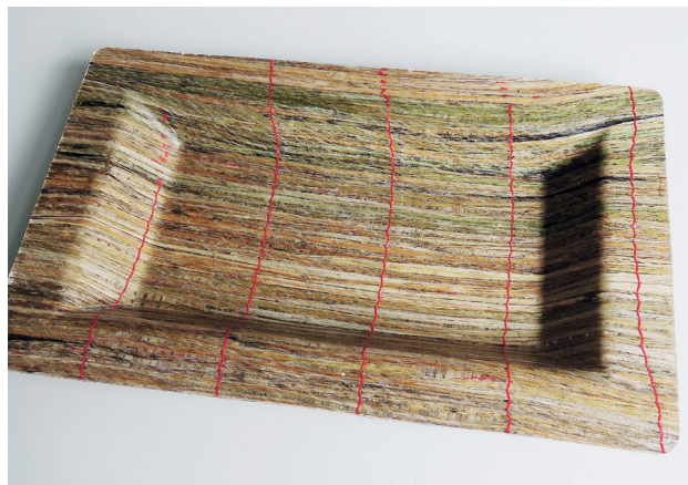
Abbildung 5: Laminat aus textilen Halbzeugen, Quelle: STFI
