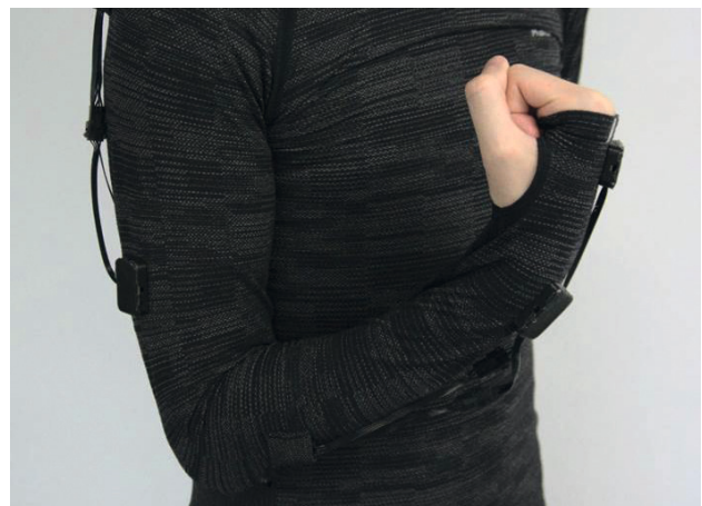
Abbildung 9: Modulares E-Textil zur Unterstützung bei der Hemiparese-Therapie, Quelle: Vorhabenkonsortium TheraTEX
