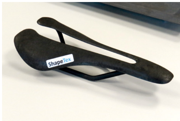
Großes Interesse erweckte ein Fahrradsattel aus mehreren Lagen RecyCarb rCF-Vliesstoff und Schienen aus „Onyx“ (Kurz-CF/Nylon) hergestellt im 3D-Druck-Verfahren. FOTO: P3N MARKETING GMBH
