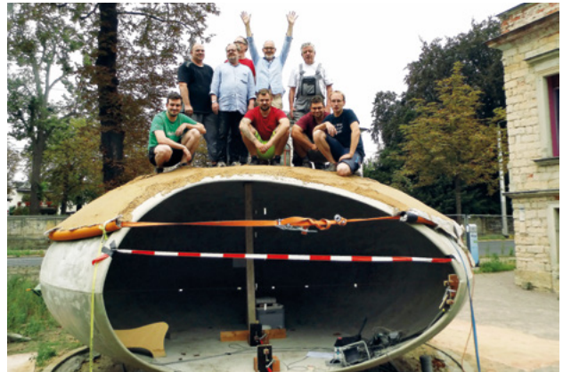
Der dünnwandige Demonstrator mit Bauteilen von 25 bis 50 mm Dicke trägt das neunköpfige Projektteam. FOTO: Ingelore Gaitzsch, Texton e.V.
