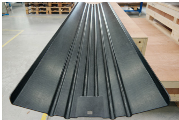
Im Vorhaben RecyCarb fertigten die Partner im Rahmen einer Machbarkeitsstudie eine CT-Liege aus rCF-Vliesstoff (vernäht). Diese besteht aus 4 Lagen Vlies (400g/m 2 ) mit einer Wandstärke von 3,3 mm und einem Faservolumengehalt von 27 %. FOTO: Schmuhl Faserverbundtechnik GmbH & Co. KG
