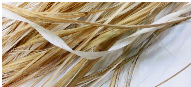
Hanfbaststreifen als Basismaterial für biogenen Heavy Tows. FOTO: STFI
