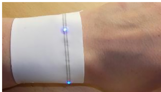
Gedruckte, flexible Leiterbahnen auf Hygienetextil, versehen mit LED und Lichtquelle. FOTO: Fraunhofer ENAS
