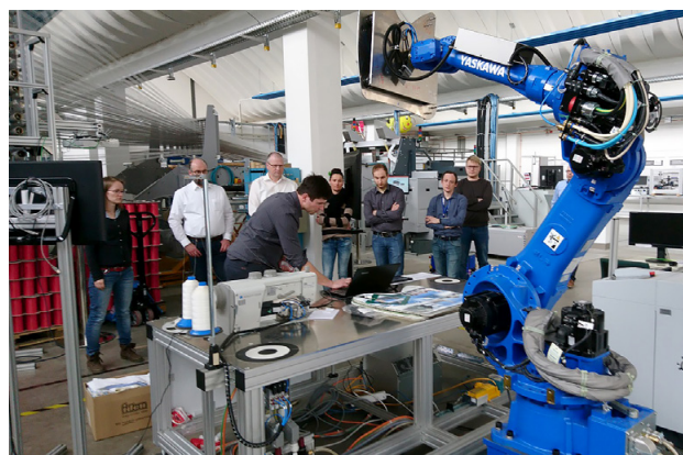
Am STFI wird eine robotergestützte Bänderfassung in Kombination mit einem Kamerasystem zur Arbeitssicherheit gezeigt. FOTO: STFI
