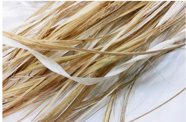
Abbildung 2: Hanfbaststreifen als Basismaterial für biogene Heavy Tows. Quelle: STFI
