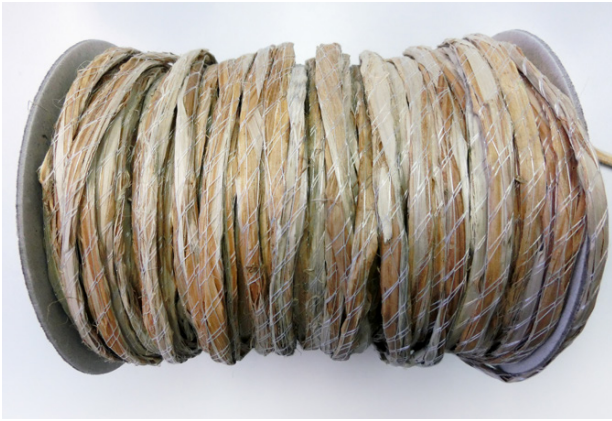
Abbildung 5: Endlosmaterial – Kernaffilierte Spule. Quelle: STFI
