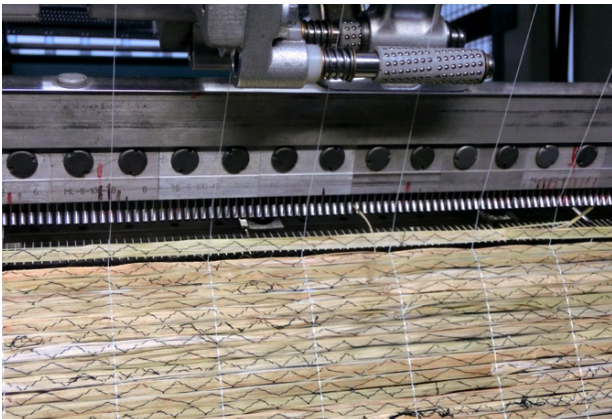
Abbildung 7: Herstellung der Halbzeuge – RS 3 MSUS-V mit Schusseintrag. Flächenbildung, 90°-Schusseintrag der bHT auf einer Verbundwirkmaschine. Quelle: STFI
