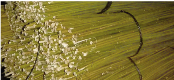
Abbildung 1: Hanfstängel als Basismaterial für biogene Heavy Tows. Quelle: STFI
