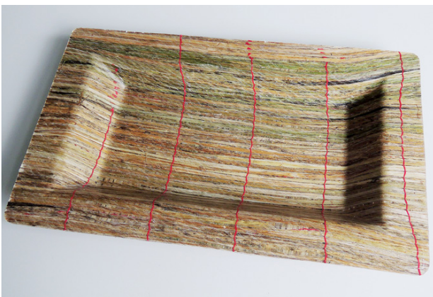
Abbildung 9: Laminate aus textilen Halbzeugen. Quelle: STFI
