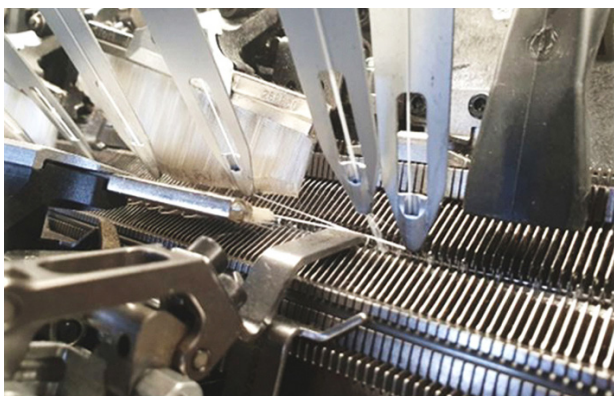
Abbildung 3: Stricktechnische Realisierung von 45° verlaufenden Strukturen. Quelle: STFI
