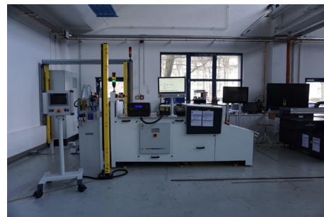
Trockenvorbehandlungsanlage im STFI
