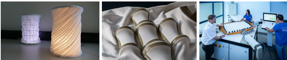
Im Projekt entwickelte Lampenschirme (links), Muster eines vorgespannten Textils (Mitte) nach Bearbeitung auf Spannrahmen (rechts; © STFI/Dirk Hanus)
