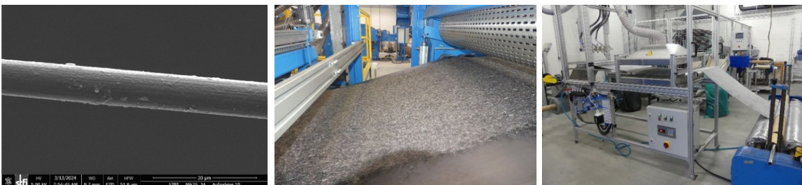
REM-Aufnahme einer wiederbeschichteten Carbonfaser (links), Herstellung von Vliesstoffen aus Carbonfasern (Mitte) und Teststand zur Wiederbeschichtung von Vliesstoffen aus Carbonfasern (rechts)
