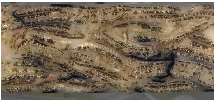
Schliffbild durch ein Hanfbast-Duroplast-Verbundbauteil
