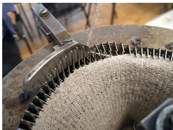
Kleinrundstricktechnik – Verarbeitung gröberer Wollgarne
