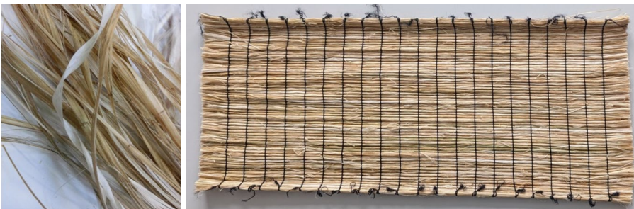
Hanfbastrinde (links) und gefertigtes Kettengewirke aus endlosen Hanfbaststrängen hergestellt mittels KEMAFIL®-Technologie (rechts)
