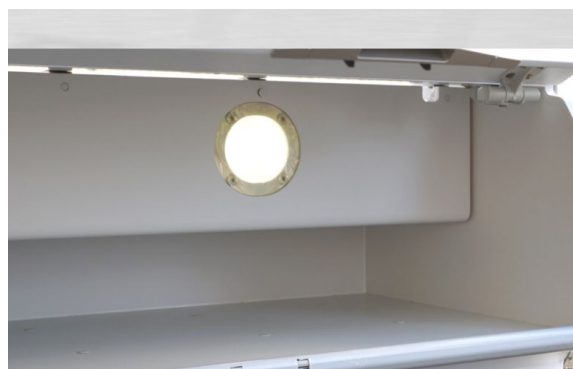
Substitution der Scharniere eines Gepäckfachs durch flexible faserverstärkte Kunststoffe (© Wingdesign)
