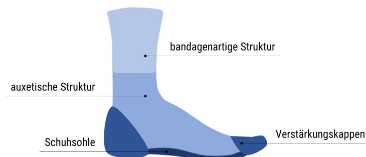
Prinzipskizze: Aufbau von Schuhen mit orthopädischem Einbauelement
