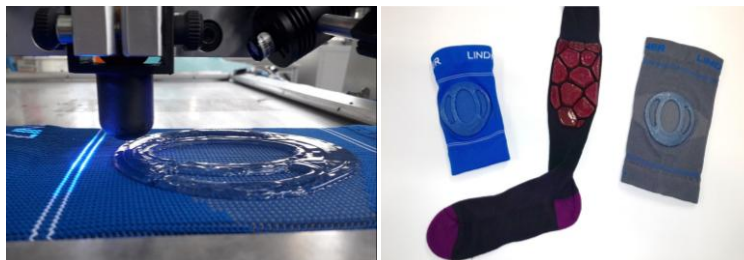
3D-Druck mit simultaner UV-Vernetzung (l.), Projektdemonstratoren (r.)
