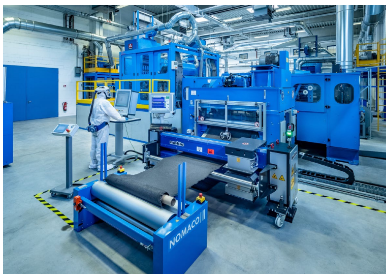
Carbonfasertechnik am STFI: Herstellung von Mischfaservliesstoffen
