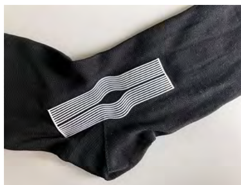
Strumpf mit 3D-gedruckter dehnungsversteifender Struktur
