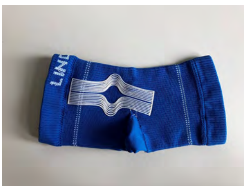
Sprunggelenksbandage mit 3D-gedruckter dehnungsversteifender Struktur
