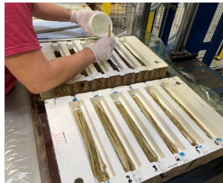
Herstellung von Faserverbundproben mit Bastfaserbewehrung
