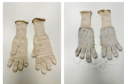
Handschuh aus 100 % MAC/CO-Garn (links) und aus MAC/CO-Garn + Umwindegarn aus Shieldex®-Garn + MAC/CO-Garn (rechts)
