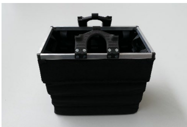
Flexibler Frachtbehälter für Transportdrohnen (links: Teleskopsystem ausgefahren; mittig: flexibel eingefahren; rechts: Teleskopsystem zusammengeschoben) © STFI
