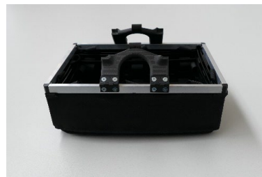
Flexibler Frachtbehälter für Transportdrohnen (links: Teleskopsystem ausgefahren; mittig: flexibel eingefahren; rechts: Teleskopsystem zusammengeschoben) © STFI
