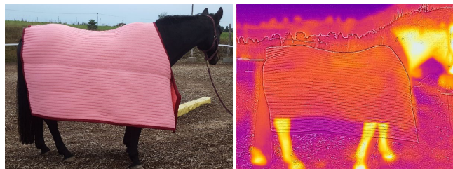
Abschwitzdecke im Praxistest: Realbild (links), das Infrarotbild zeigt die Verdunstungskühlung (rechts)
