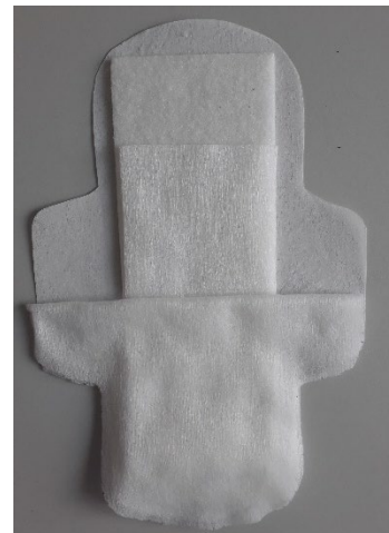
Abb. 1: Hygienepad mit Lagen- aufbau: TopSheet, ADL, Saugkern, BackSheet (von oben nach unten)
