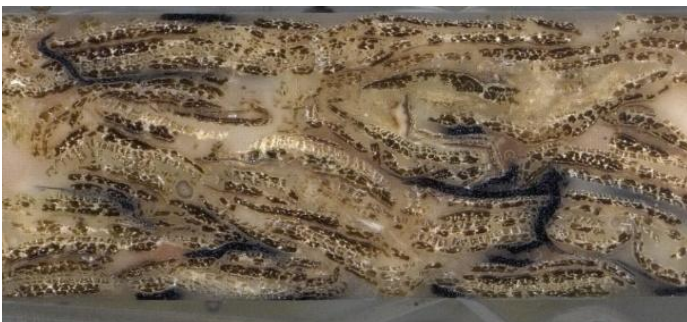
Schliffbild durch ein Hanfbast-Duroplast-Verbundbauteil
