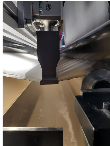
Abb.: Ultraschall-Sonotrode bei der Vliesstoff-Entwässerung-Verfestigung
