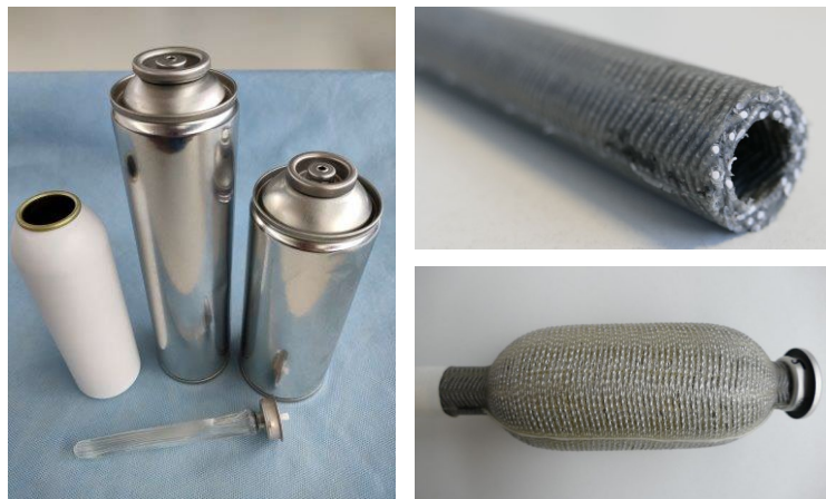
Abb.: Zwei-Kammer-Aerosoldosen (links), Elastischer Schlauch als Verbundwerkstoff aus zweilagigem Geflecht und PU-Matrix (rechts)
