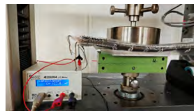
Druckspannungsverformungseigenschaften DIN EN ISO 3386 1
