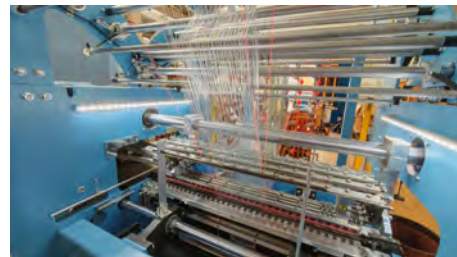
Herstellung der Flächenelemente auf einer Wirkmaschine
