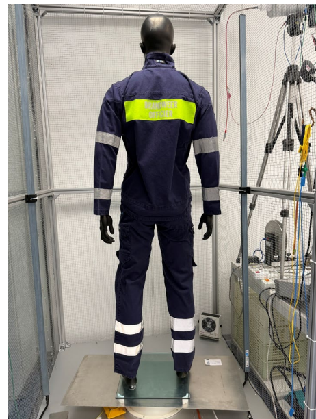
Messplatz (Teilansicht) mit STFI-Elektrostatik-Personenmodell zur Erprobung des Ladungstransfer-Elektrodensystems
