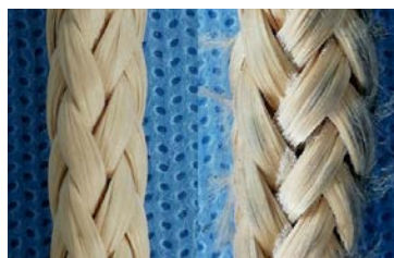
Probe Technora®, neu (links), belastet (rechts)
